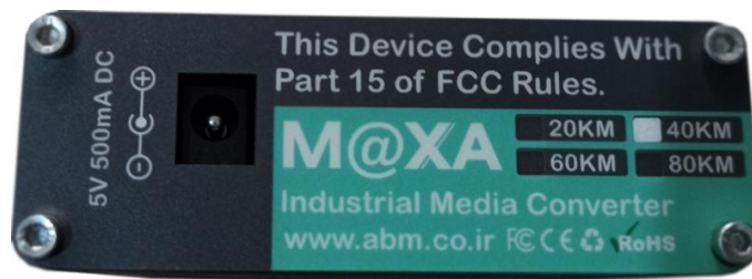
شکل ۲: محل تغذیه آداپتور و برد مسافتی ترنسیور مدیا کانورتور
